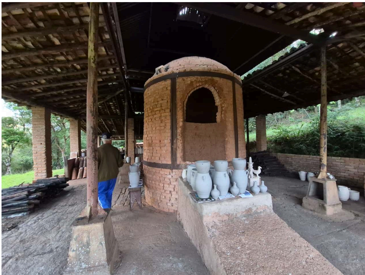
Figura 26: Forno a lenha, para a queima de grandes quantidades de peças.
