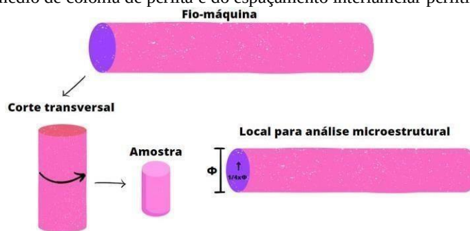
Figura 4.2- Representação esquemática das posições de amostragem ao longo da seção transversal do fio-máquina (superfície, meio-raio e centro), indicando os locais de análise microestrutural e de medição do tamanho médio de colônia de perlita e do espaçamento interlamelar perlítico.
