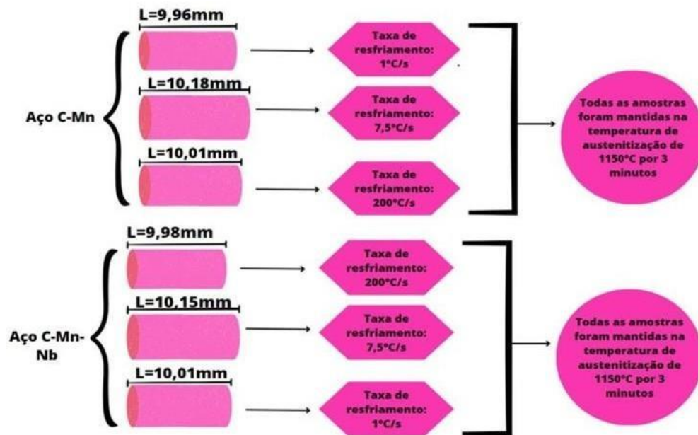
Figura 4.10 - Representação esquemática do processo de austenitização, com indicação dos comprimentos iniciais de cada corpo de prova.
