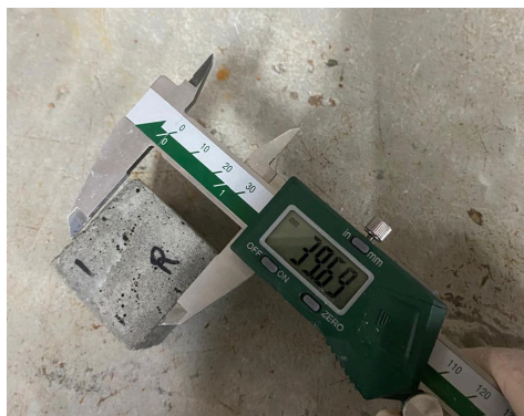
Figura 7 – Medição das dimensões do corpo de prova com paquímetro digital.
