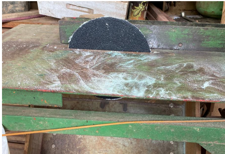
Figura 4 – Equipamento utilizado para pulverização do PET
