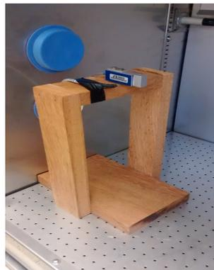
Figura 13 – Montagem mecânica da célula de carga industrial ligada ao sistema.
