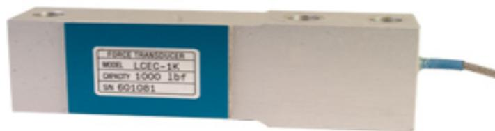
Figura 12 – Célula de carga industrial utilizada neste trabalho.
