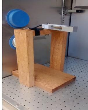
Figura 11 – Montagem mecânica da célula de carga de baixo custo ligada ao sistema.
