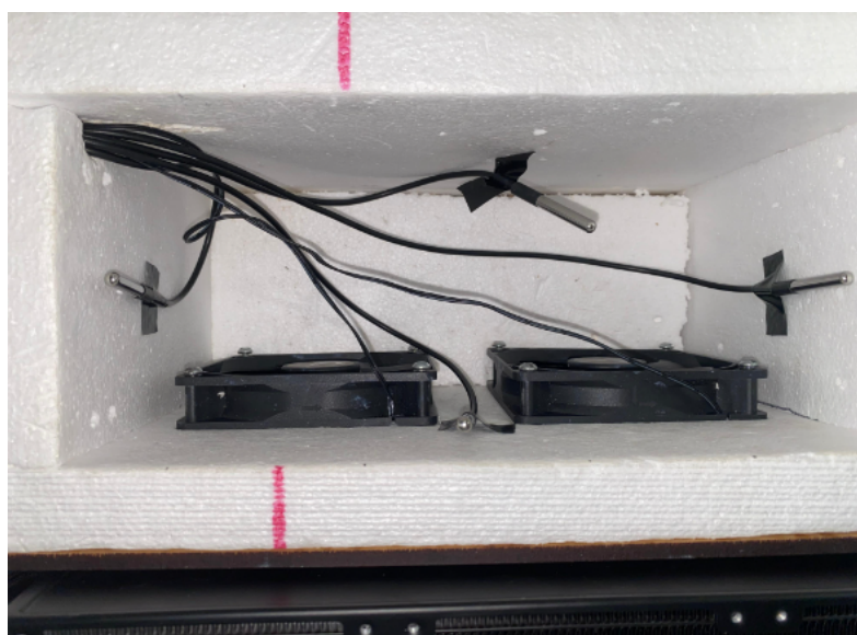
Figura 3 – 4 sensores DS18B20 (internos).
