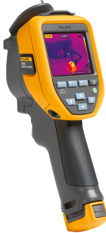
Figura 6 – Termovisor infravermelho industrial Fluke, modelo TiS60+, utilizado como instrumento padrão de referência térmica.
