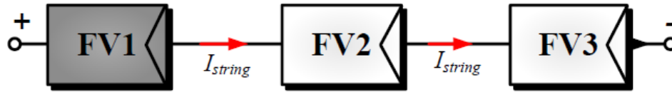
(a) Série fotovoltaica com sombreamento
