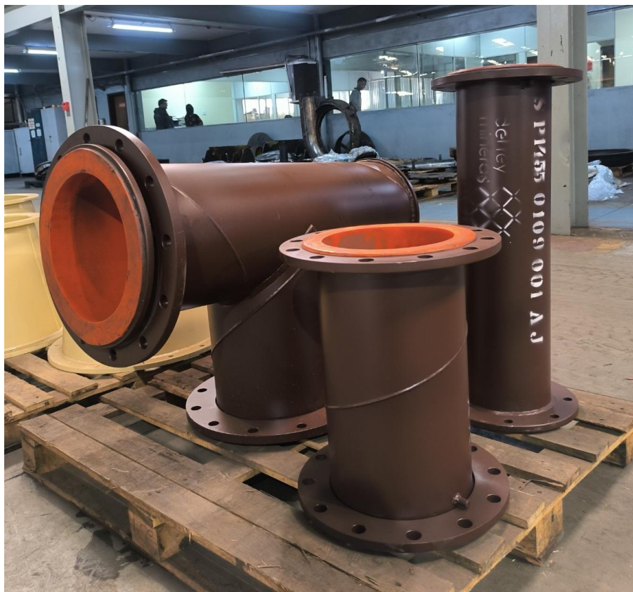
Figura 8 – Tubulação revestida internamente com poliuretano (PU); Fonte: Pesquisa Direta
