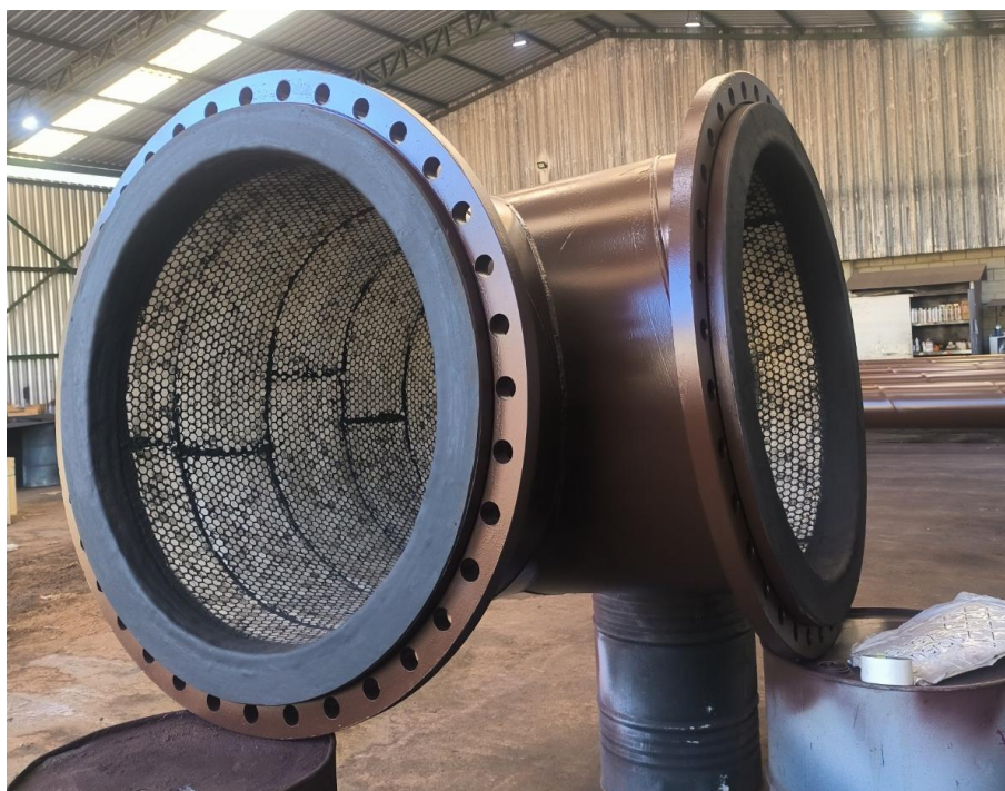
Figura 10 – Tubulação revestida internamente com borracha + cerâmica. Fonte: Pesquisa Direta
