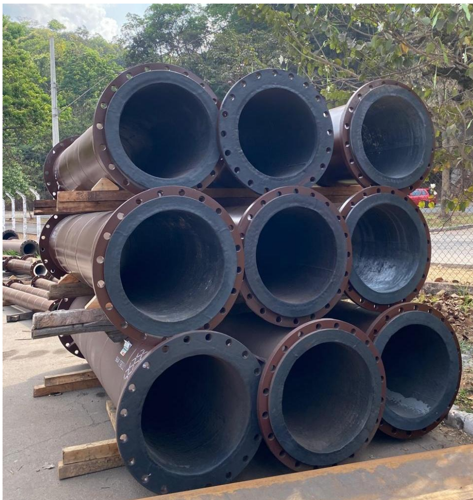
Figura 9 – Tubulação revestida internamente com borracha natural. Fonte: Pesquisa Direta
