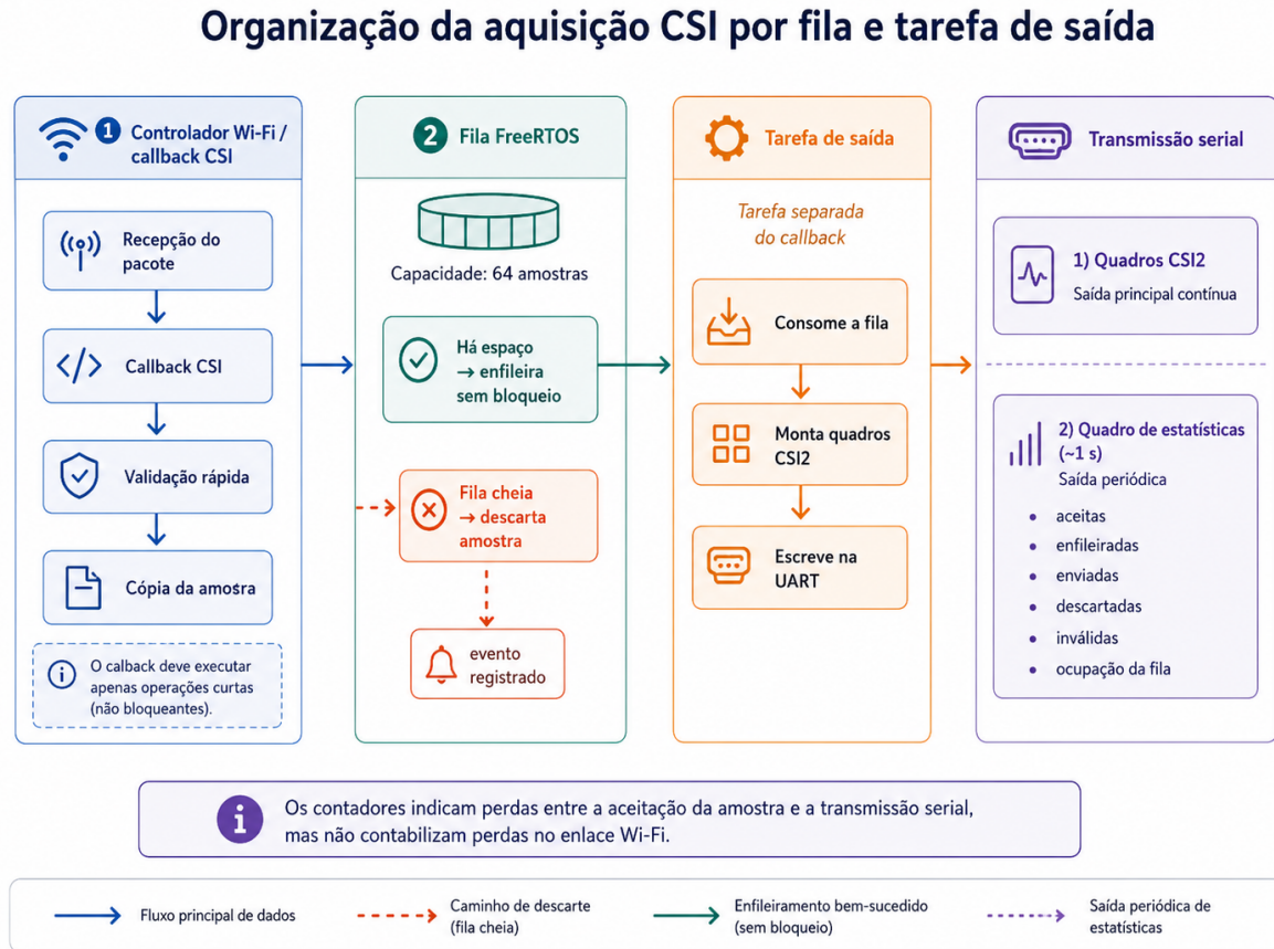
Figura 8 – Organização da aquisição CSI por meio de fila e tarefa de saída
