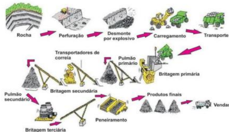
Figura 3 - Fluxograma do Processo Produtivo de uma Mineradora Fonte: Iramina et al. (2009, p. 506)
