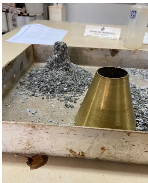
Figura 11 - Ensaio de massa específica.
