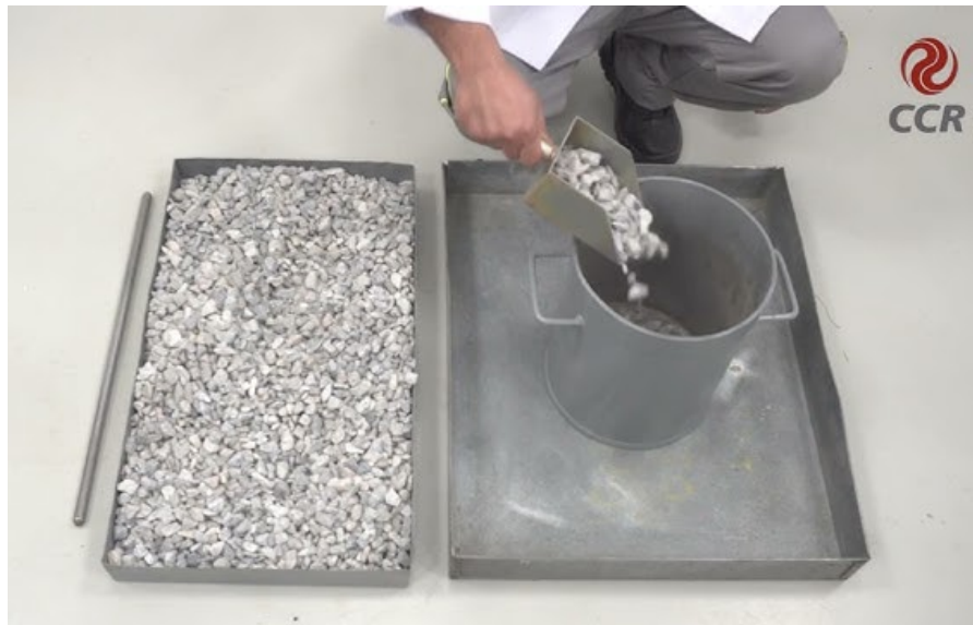
Figura 19 - Ensaio de determinação da massa unitária.
