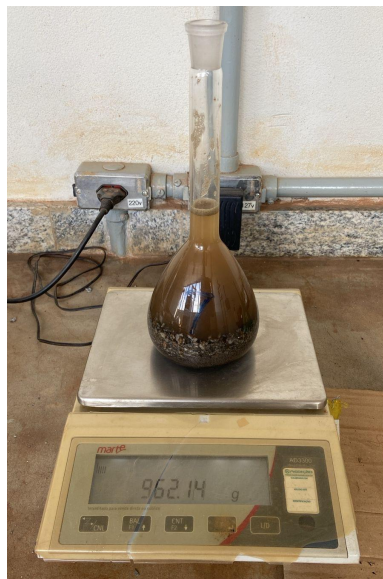
Figura 1 - Pesagem para ensaio de equivalente de areia com o RAP.
