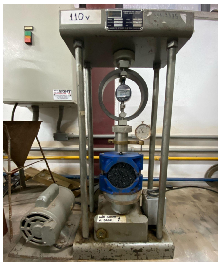
Figura 17 - Ensaio de estabilidade e fluência Marshall.
