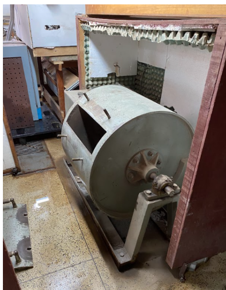
Figura 12 - Ensaio de abrasão de Los Angeles.
