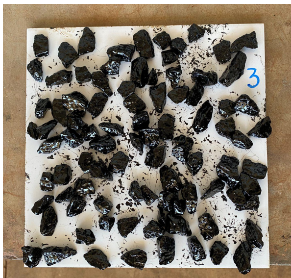
Figura 14 - Ensaio de adesividade ao ligante.
