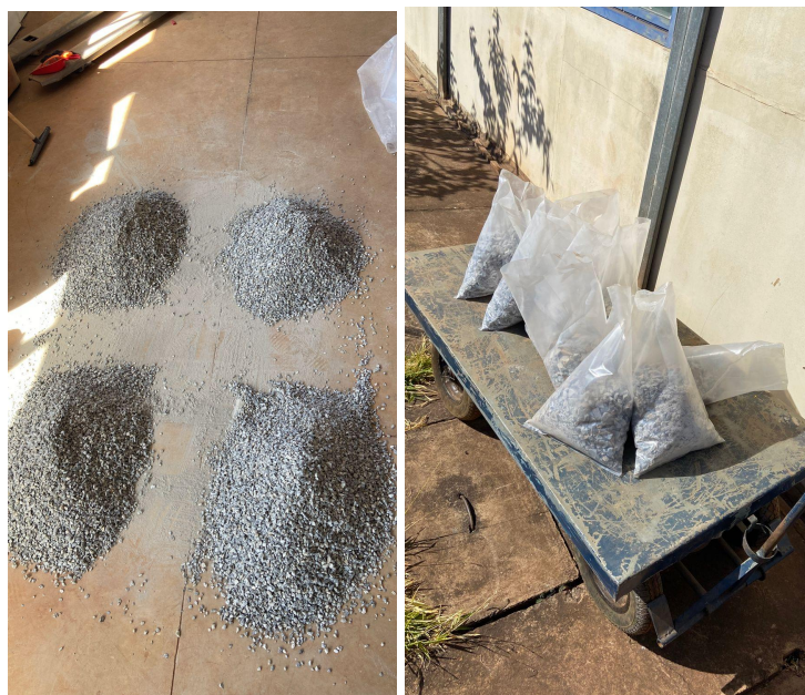
Figuras 3 e 4 - Quarteamento e separação do material.
