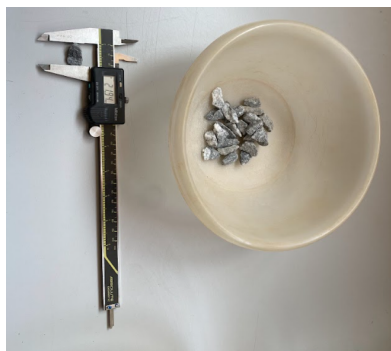
Figura 9 - Medição com paquímetro para o índice de forma.
