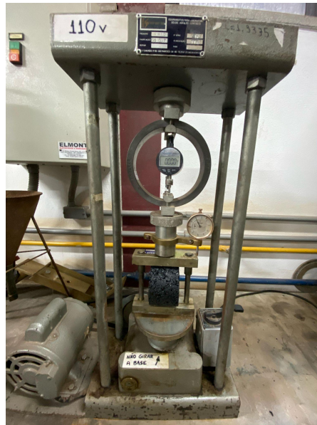
Figura 18 - Ensaio de Resistência à Tração por Compressão Diametral.
