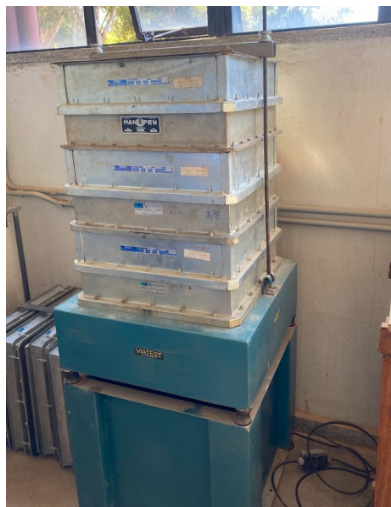
Figura 5 - Peneiramento da brita 1.
