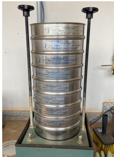
Figura 7 - Peneiramento da brita 0.
