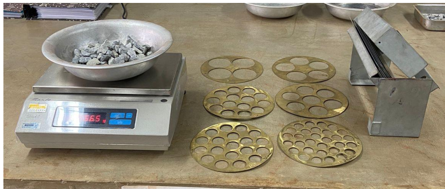
Figura 10 - Medição com crivo para o índice de forma.
