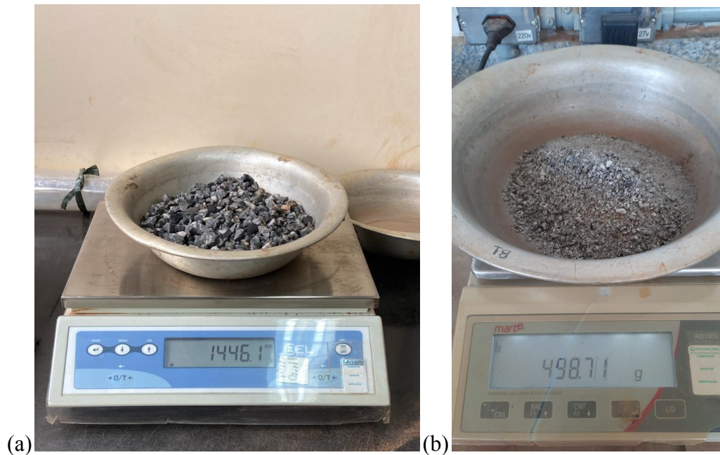
Figura 2 - Massa específica de agregado graúdo (a) e agregado miúdo (b)
