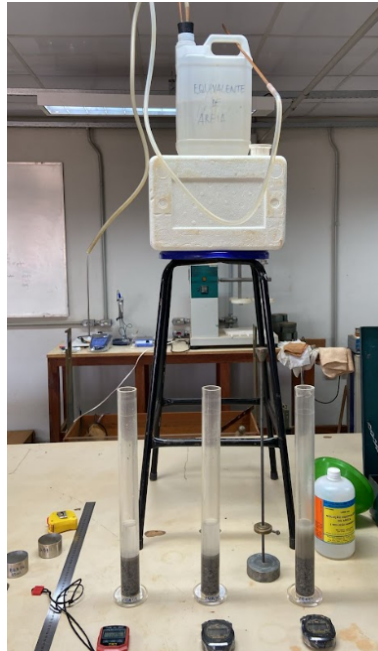
Figura 8 - Ensaio Equivalente de areia.
