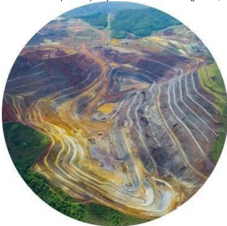
Figura 3. 3 - Cava a céu aberto para disposição de lama - Mina Alegria Sul, Samarco, Mariana
