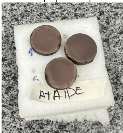
Figura 4. 4 - Amostras preparadas para análise MEV/EDS
