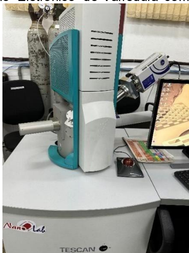
Figura 4. 5 - Microscópio Eletrônico de Varredura com sistema EDS acoplado
