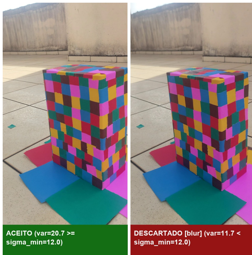
Figura 6: Exemplo real do Estágio 1 (dataset de validação, \sigma_{\min} = 12,0 ): frame aceito à esquerda (variância do Laplaciano = 20, 7) e frame descartado à direita (variância = 11, 7), ambos da mesma sessão e próximos na sequência de captura.
