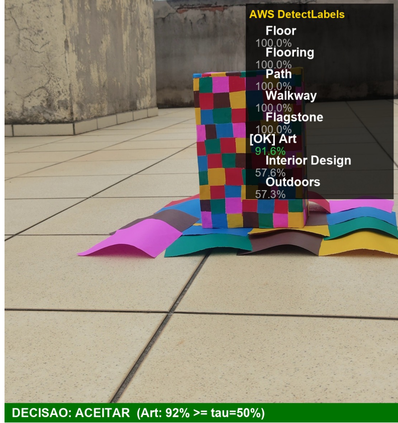
Figura 7: Saída real da API AWS Rekognition DetectLabels para um frame aceito (sessão 1, frame 002). O rótulo Art (91,6%) foi detectado acima do limiar \tau = 50\% e pertence à lista alvo, resultando na decisão ACEITAR exibida na barra inferior.
