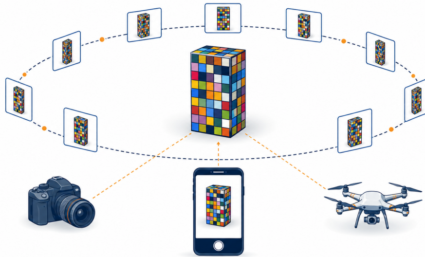
Figura 1: Representação das formas de aquisição de múltiplas vistas de um objeto para reconstrução 3D, com destaque para a captura orbital por smartphone adotada neste trabalho.
