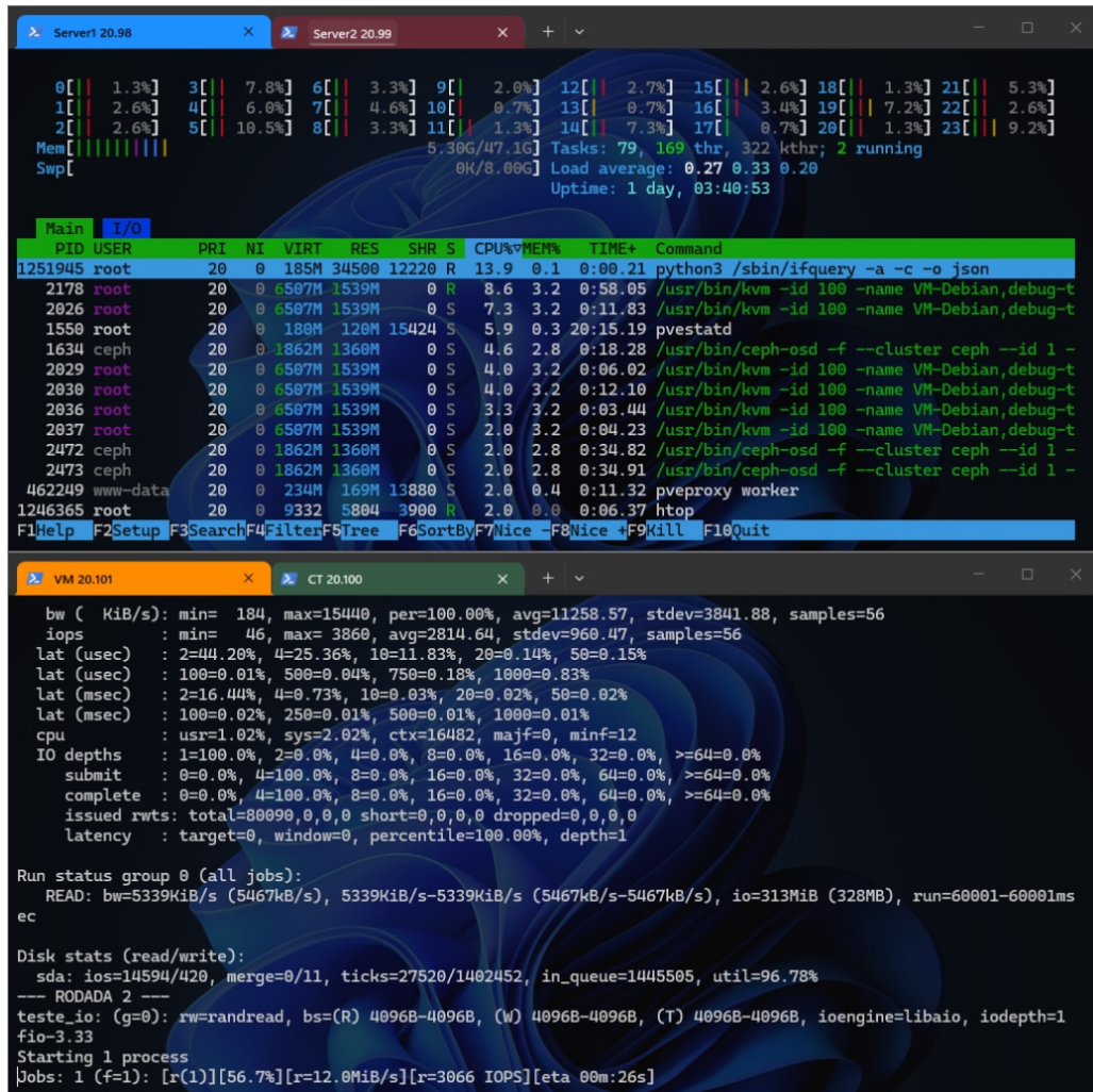
Figura 10 – Monitoramento de recursos exibindo a alocação de tempo de sistema (sy) da CPU.
