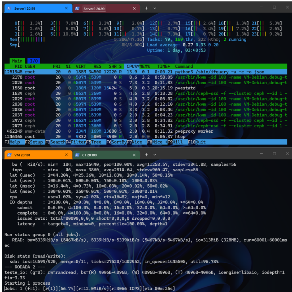
Figura 8 – Monitoramento de rede evidenciando o estresse físico na interface de 10 Gbps durante o ensaio.
