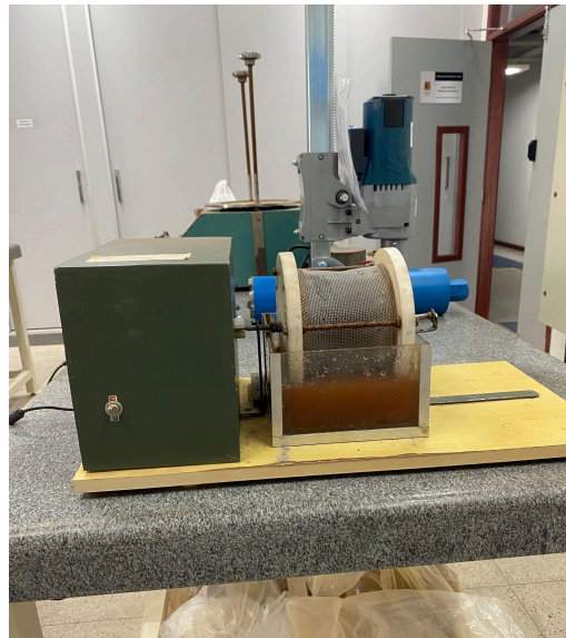
Figura 30 - Amostras no aparelho do ensaio Slake Durability no laboratório do DEMIN.
