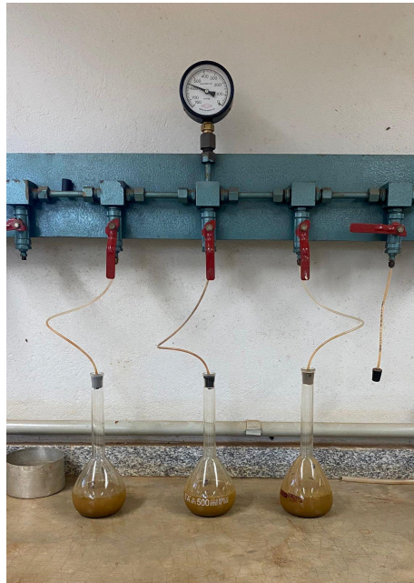
Figura 28 - Material sendo ensaiado com auxílio de bomba de vácuo.
