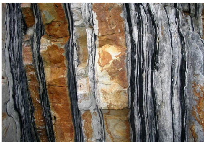
Figura 5 - Exemplo de maciço rochoso anisotrópico.
