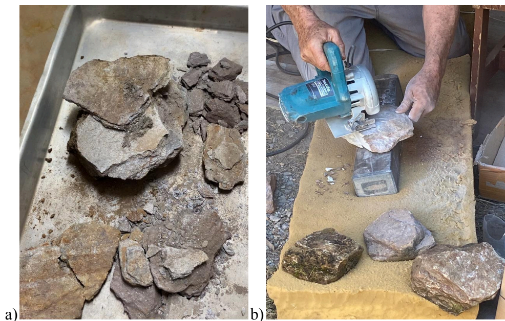
Figura 18 - a) Amostra intensamente alterada e branda; b) Corte de amostras com auxílio de serra mármore.
