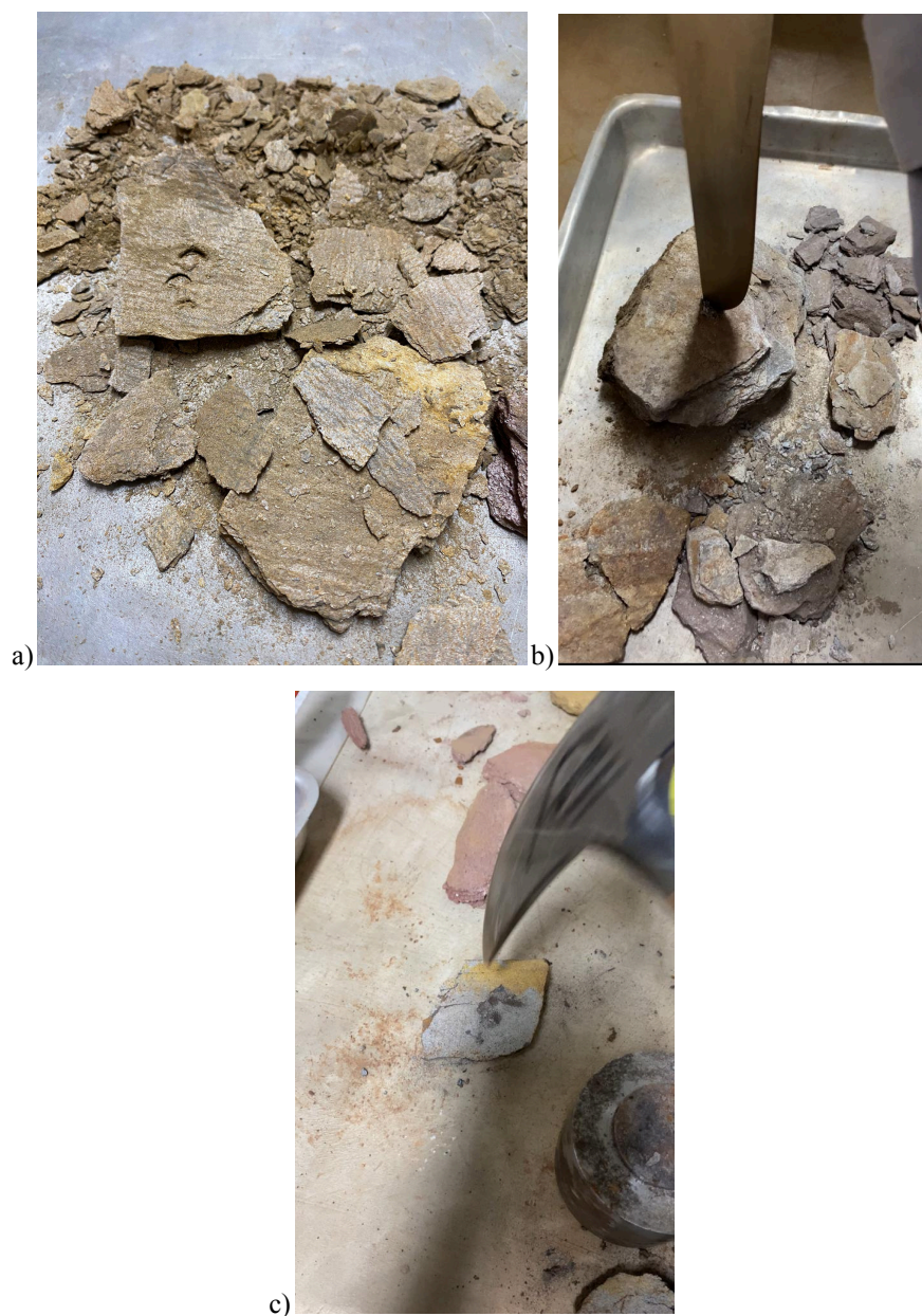
Figura 19 - Fragilidades das amostras. a) Amostra Vila Aparecida sendo facilmente marcada com a unha b) Amostra São Francisco sendo furada facilmente pela ponta da faca c) Amostra Morro da Forca sendo fraturada facilmente ao ser golpeada com a ponta do martelo.
