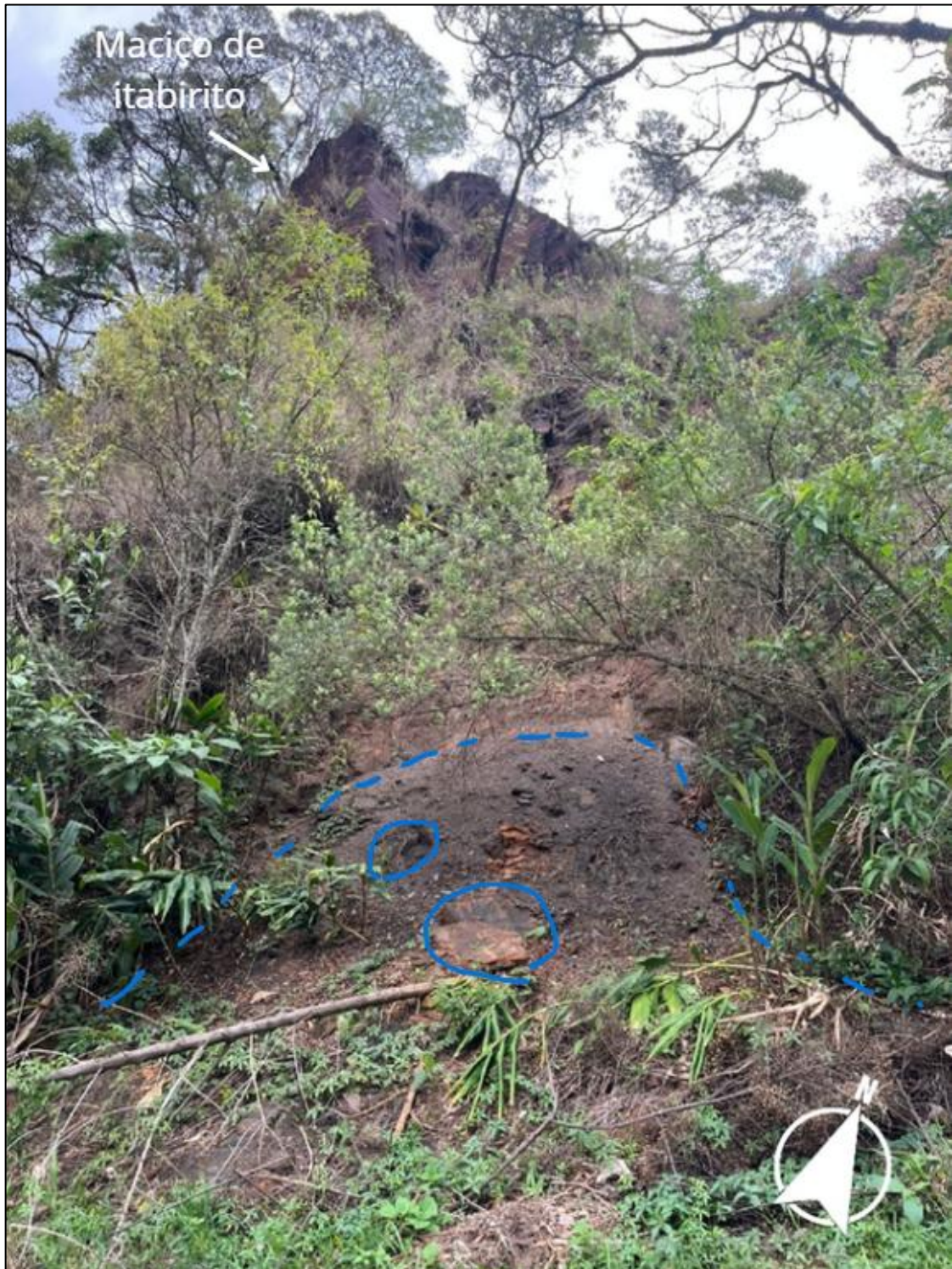
Figura 6.13 - Talude no P4. Na porção superior, indicada pela seta branca, observa-se o maciço de itabirito com planos de fratura. Em azul, destacam-se blocos, matacões e fragmentos de itabirito dispersos ao longo da encosta, abaixo do afloramento.
