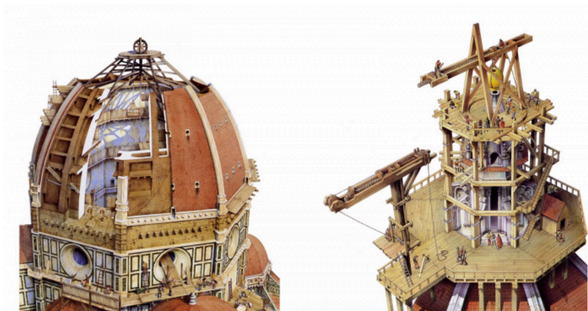
Figura 01 — Ilustração do processo construtivo da cúpula da Catedral de Santa Maria del Fiore, destacando dispositivos técnicos e estruturas, utilizada como apoio visual à leitura alegórica do episódio
