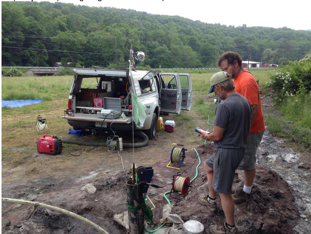
Figura 6: Operação de perfilagem geofísica em campo.
