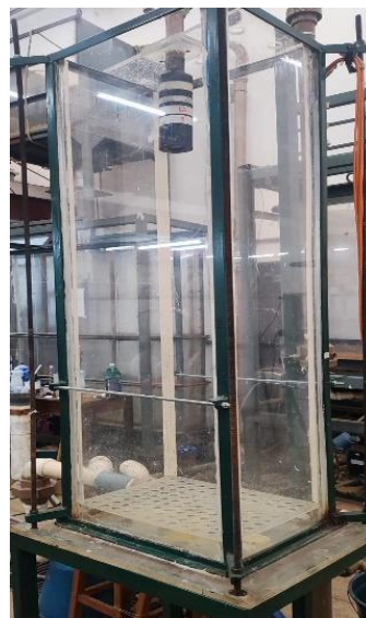
Figura 4.2 - Posicionamento da válvula na parte superior do molde de acrílico.
