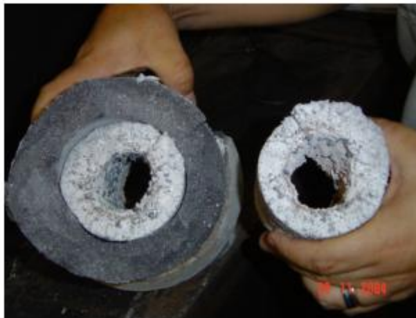
Figura 1.1 - Apresentação do fenômeno estudado: o clogging . Tubo submerso com depósito de alumina ( clogging ) no diâmetro
