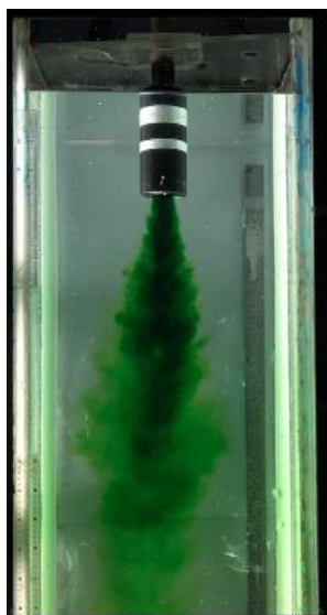
Figura 4.5 – Ensaio de penetração do jato via injeção de corante.
