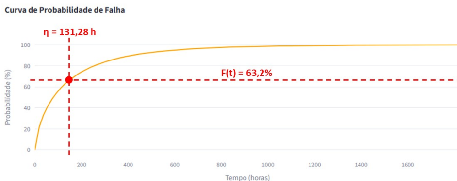
Figura 26 – Curva de probabilidade de falha da amostra final. Fonte: Ferramenta Reliability Asset Management
