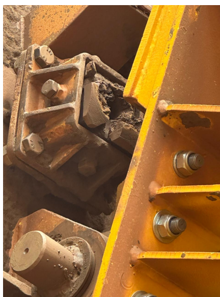
Figura 32 – Falha no protótipo do batente de poliuretano. Fonte: Pesquisa Direta (2026)
