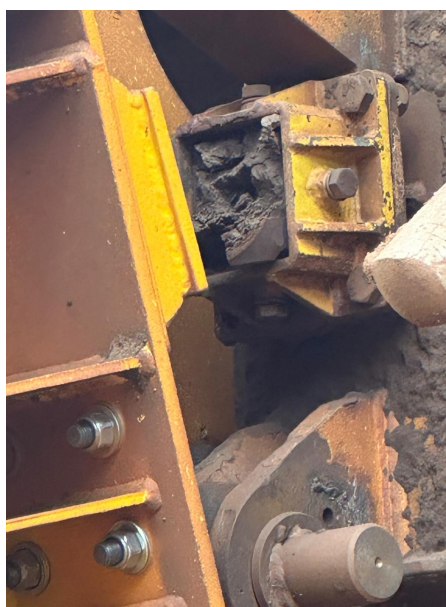
Figura 31 – Falha no protótipo do batente de poliuretano. Fonte: Pesquisa Direta (2026)
