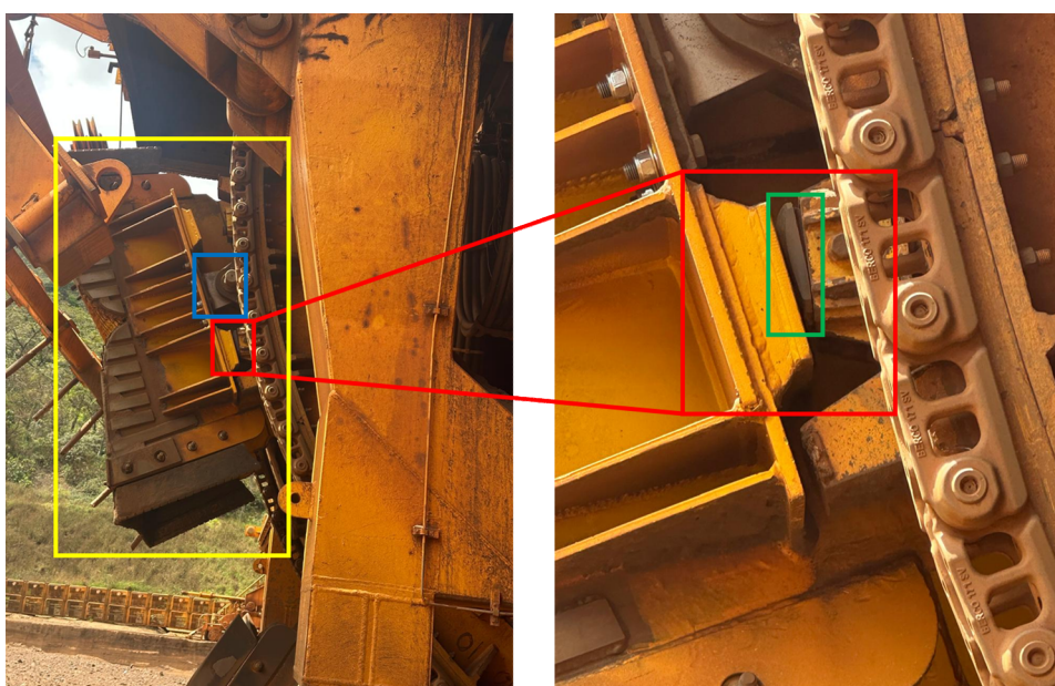
Figura 17 – Sistema de Amortecimento da Retomadora. Fonte: Pesquisa Direta (2026)
