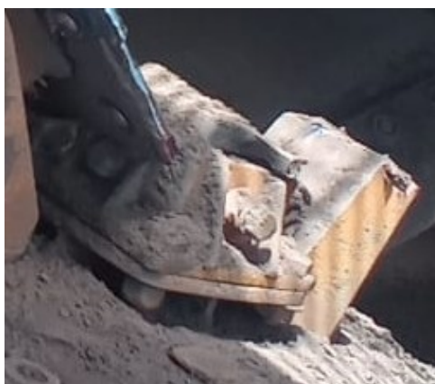
Figura 19 – Falha em batente de borracha. Fonte: Pesquisa Direta (2026)
