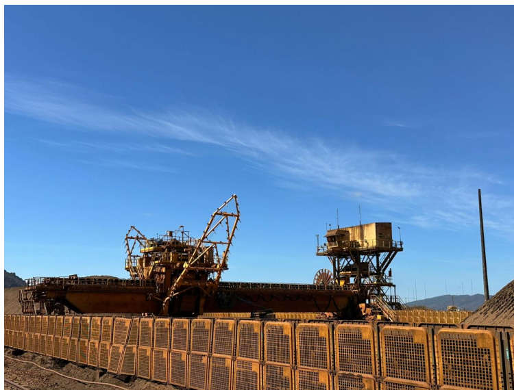
Figura 13 – Retomadora Roda de Caçamba Tipo Ponte. Fonte: Pesquisa Direta (2026)
