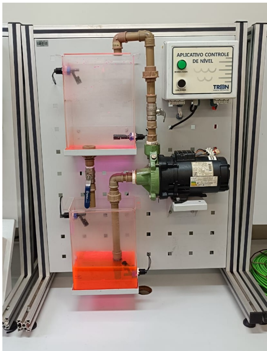
Figura 15 – Protótipo didático antes das modificações realizadas para implementação da leitura analógica de nível e do controle PID. Fonte: Acervo do autor (2026).
