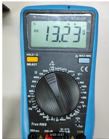
Figura 23 – Medição da corrente consumida durante o modo Deep Sleep .
