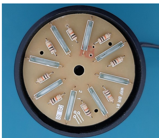
Figura 8 – Esquema de funcionamento interno e sensores Reed Switch do DV10. Fonte: Straub (2019)
