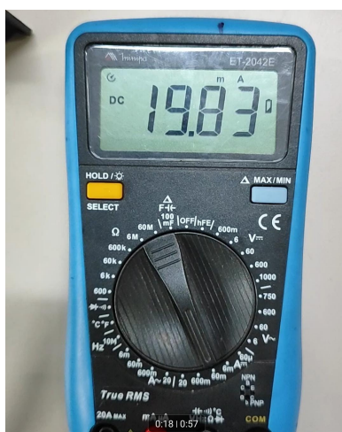
Figura 21 – Medição da corrente consumida durante a etapa de aquisição dos sensores.
