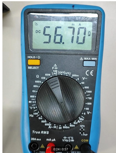
Figura 22 – Medição da corrente consumida durante a transmissão dos dados via módulo LoRa.
