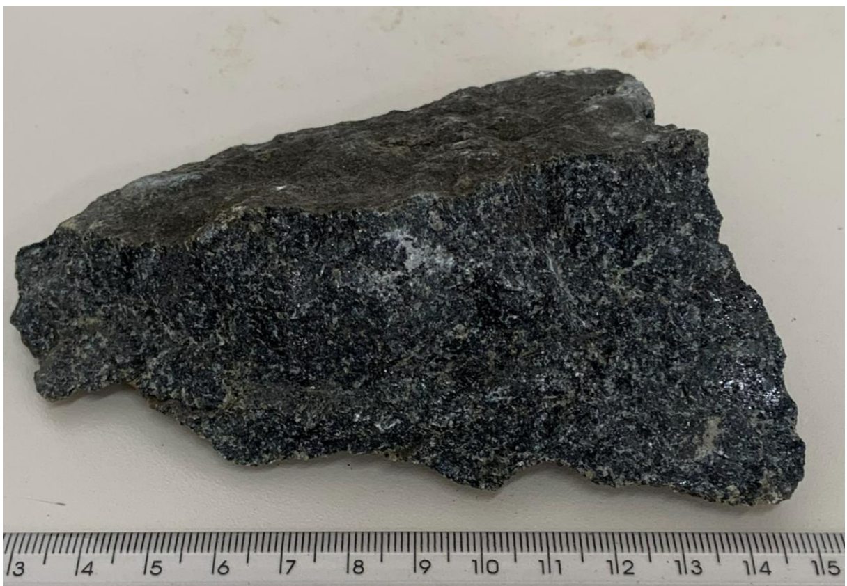
Figura 27: Amostra de rocha máfica, composta por plagioclásio e minerais máficos (Ponto VN16), interpretado como correspondente aos gabros do núcleo do PVN
