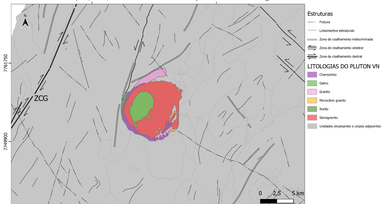
Figura 22: Mapa das principais estruturas geológicas da região do Plúton Venda Nova, com destaque para a Zona de Cisalhamento Guaçuí (ZCG). As estruturas foram compiladas da base cartográfica da SGB.
