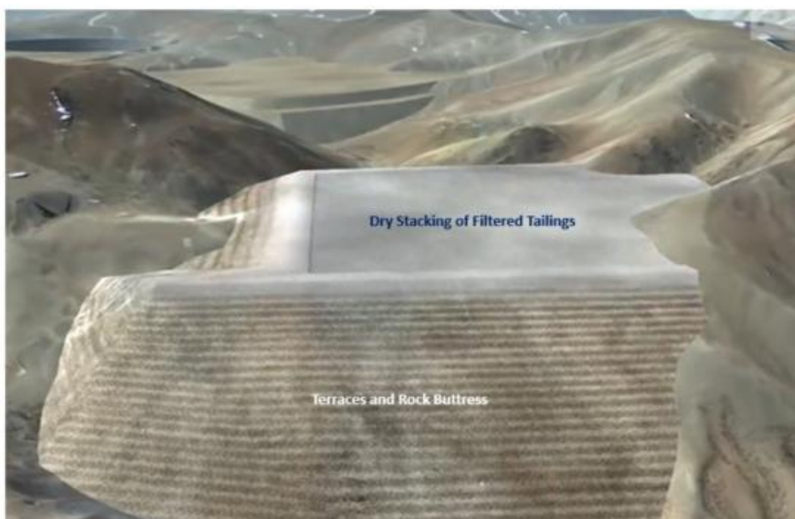
Figura 4 - Modelo de uma pilha de rejeito filtrado
