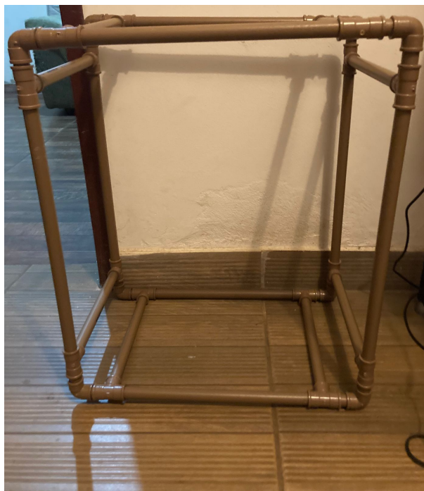
Figura 2 – Base em tubos PVC
