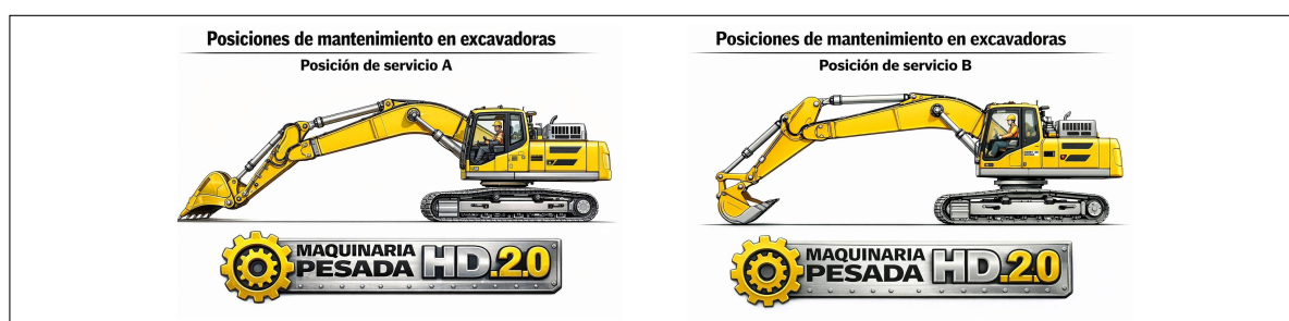
Figura 3 – Posições de serviço A e B em escavadeira hidráulica. Fonte: Máquinas Pesadas HD 2.0.
