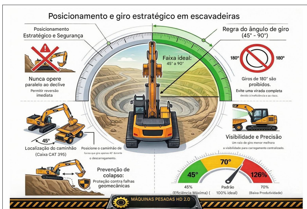
Figura 4 – Posicionamento e giro estratégico em escavadeiras. Fonte: Máquinas Pesadas HD 2.0.
