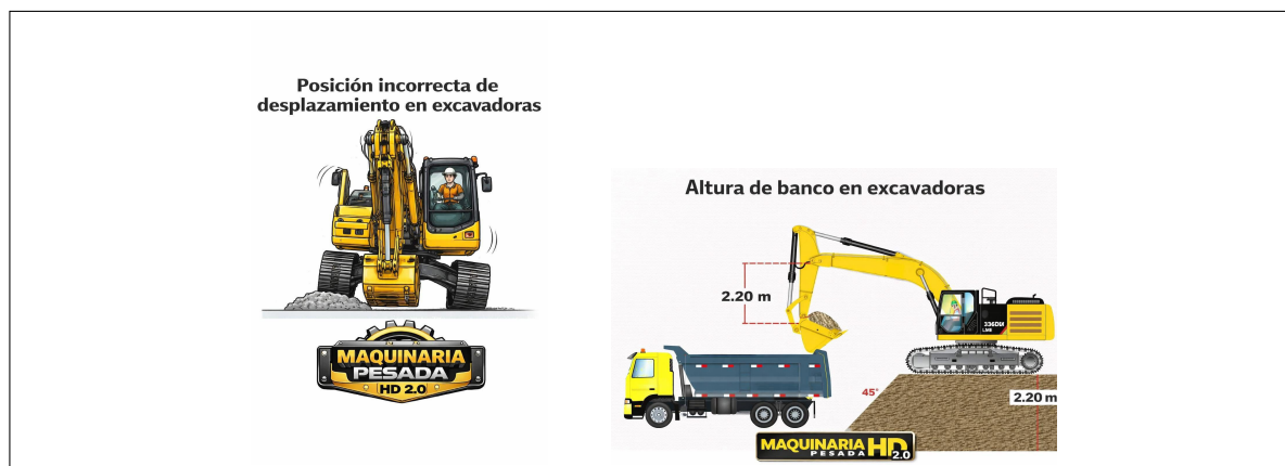
Figura 2 – Posição incorreta de deslocamento e altura de banco em operação de escavadeira hidráulica. Fonte: Máquinas Pesadas HD 2.0.
