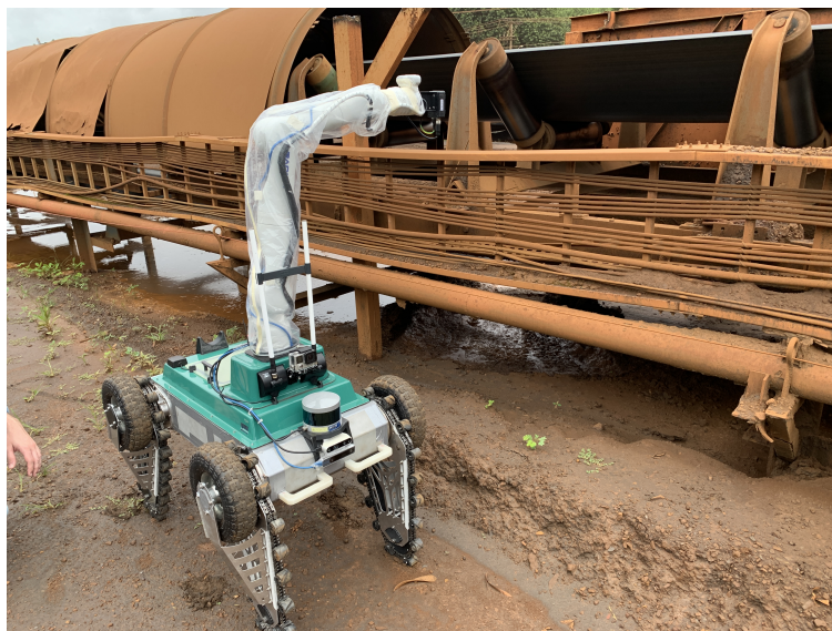
Figura 2 – ROSI realizando uma atividade de inspeção termográfica em uma correia transportadora.
