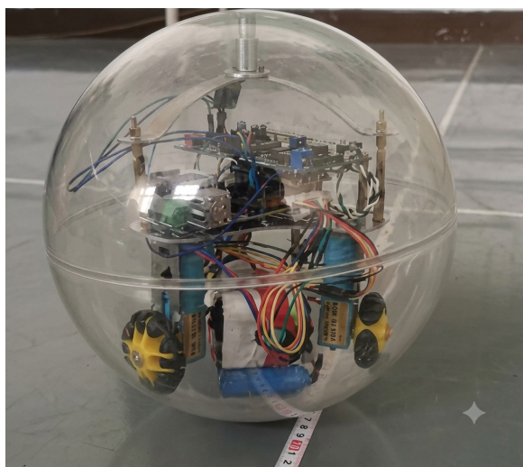
Figura 7 – Robô esférico para monitoramento de radiação.
