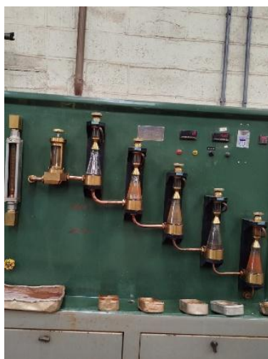
Figura 14: cyclosizer utilizado para a determinação da distribuição granulométrica do rejeito.
