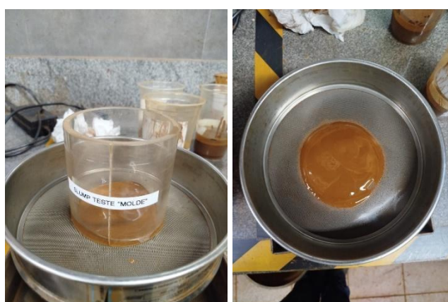
Figura 22: a) slump test sem a adição de reagentes, dentro do molde; b) resultado do slump test sem a adição de reagentes.
