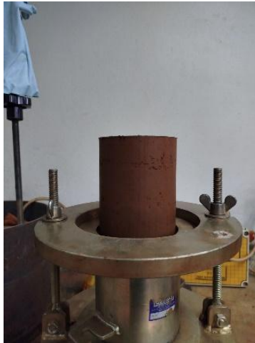
Figura 23: Corpo de prova resultante do ensaio de compactação.
