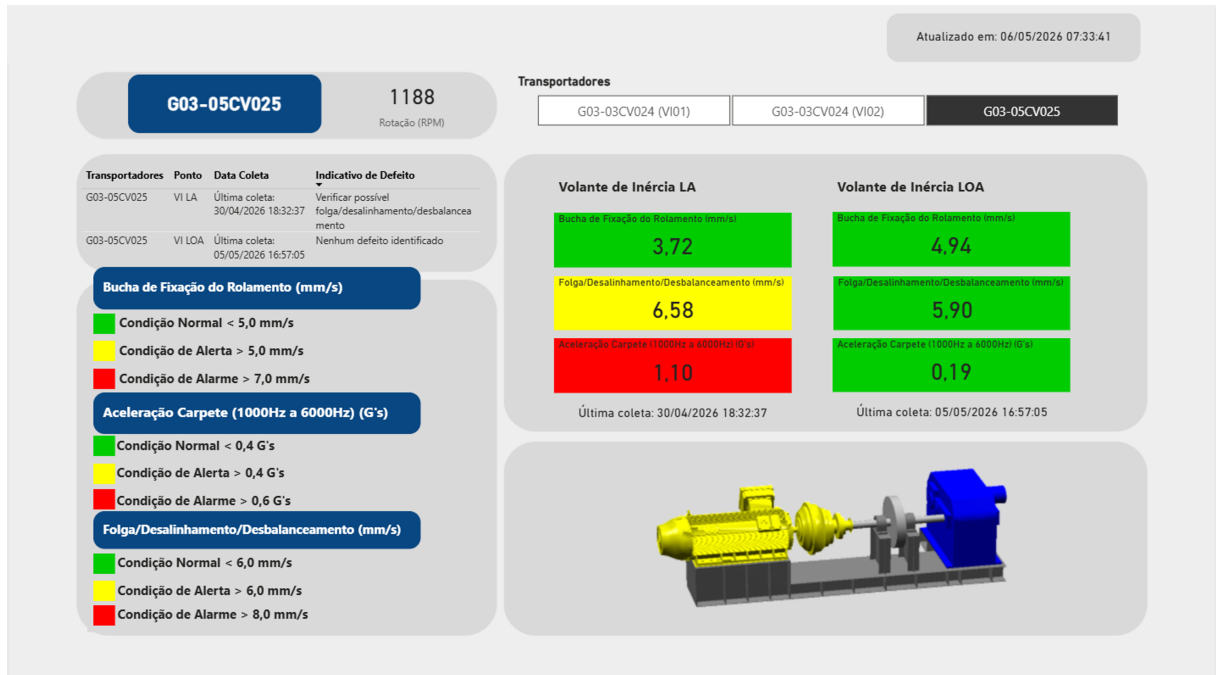
Figura 3 – Dashboard de visão consolidada para transportadores.
