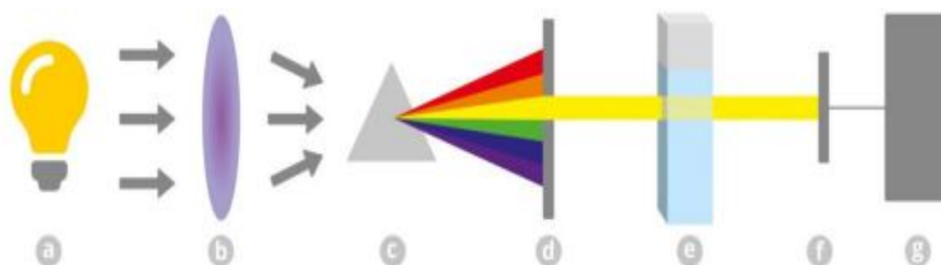
Figura 16 - Etapas de uma medida espectrofotométrica: (a) Fonte de luz, (b) Lente Colimadora, (c) Prisma ou rede de difração, (d) Fenda seletora, (e) Cubeta (vidro, quartzo), (f) Detector, (g) Leitor.
