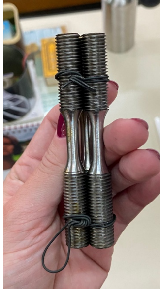
Figura 4.9: corpos de prova fixados em sua cabeça para realização dos tratamentos térmicos de austêmpera
