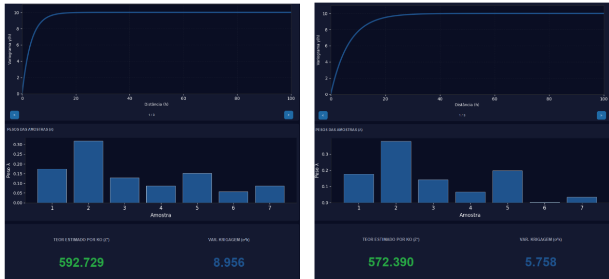
Figura 36 - Variogramas, pesos das amostras, estimativa e variância de krigagem obtidos no KrigMine2D para modelos exponenciais com mesmo patamar e efeito pepita nulo, diferindo apenas no alcance: (a) a = 10 m; (b) a = 20 m.
