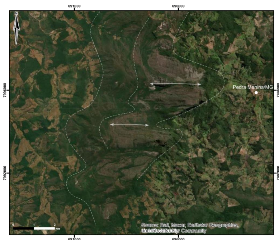
Figura 53 - Dobras macroscópicas com eixos E-W paralelos às lineações de intersecção entre acamamento e xistosidade. Ocorrência registrada no distrito de Pedra Menina/MG, região de interface entre a Serra do Espinhaço Meridional e o Complexo Guanhães.
