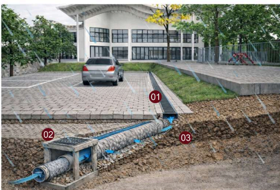
Figura 40: Diagrama Básico do Funcionamento da Drenagem da Área Externa
