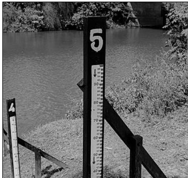
Figura 4.6 – Régua linimétrica Fonte: Adaptado de Brasil de Fato(2021).
