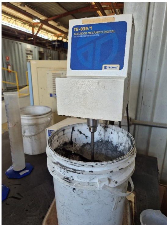
Figura 4 - Agitador mecânico digital utilizado na homogeneização da polpa.
