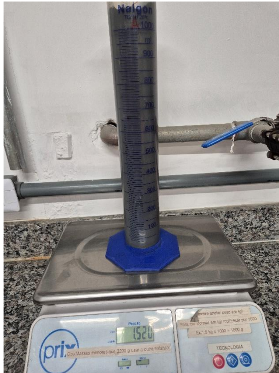
Figura 5 - Determinação da densidade da polpa em proveta graduada de 1000 mL.
