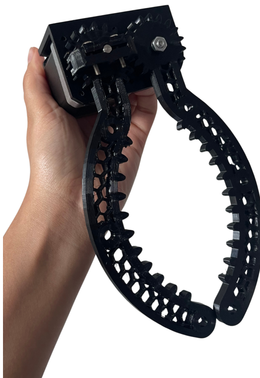
Figura 19 – Protótipo da garra mecânica impressa em 3D, montada com o motor - Completo.
