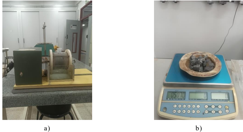
Figura 4.6 Realização do ensaio de durabilidade; a) Aparelho de realização do teste; b) Pesagem da amostra seca em estufa.
