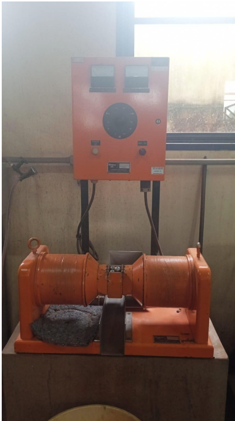
Figura 4.1.3: Separador magnético de média intensidade
