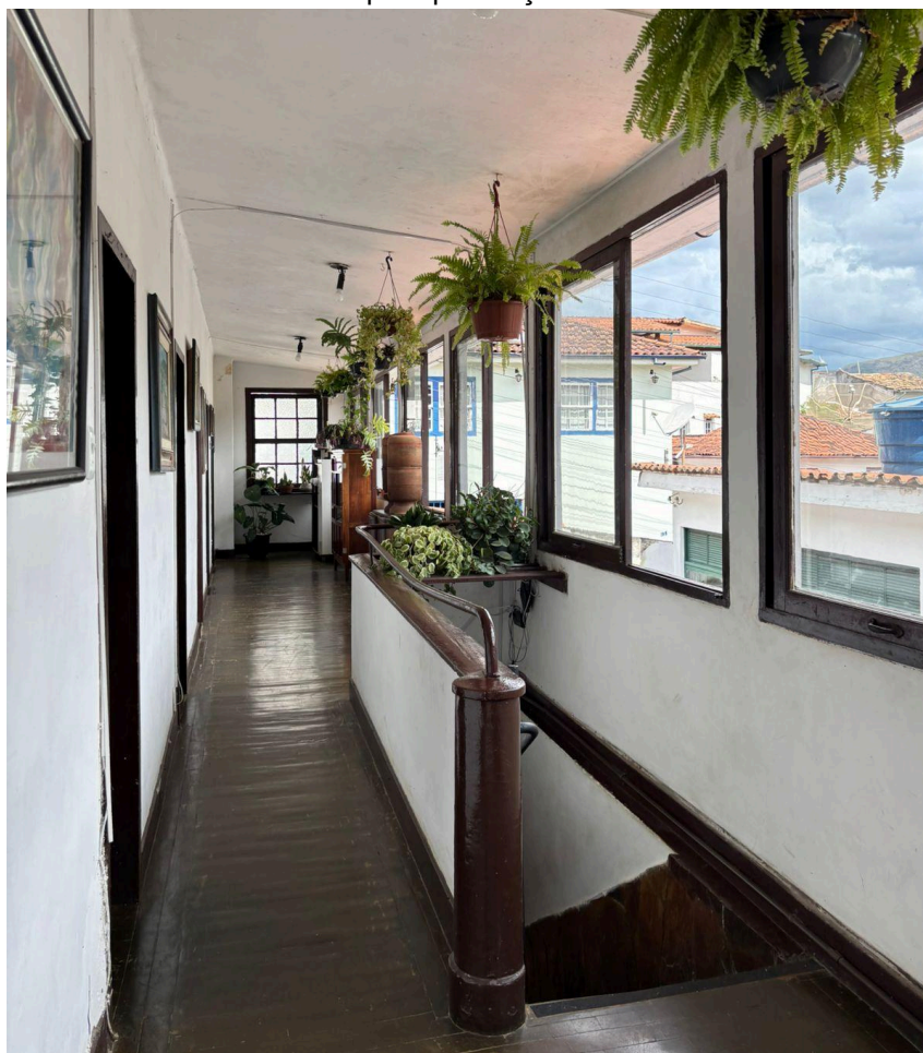
Figura 44: Corredor interno com ampla sequência de janelas, demonstrando a estratégia de iluminação natural e o fluxo contínuo de ar para prevenção de umidade.
