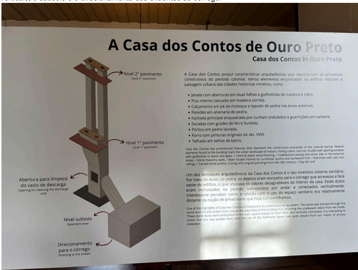
Figura 12: Esquema do sistema de saneamento da Casa dos Contos, evidenciando os dutos verticais, o subsolo e o direcionamento dos efluentes ao córrego.
