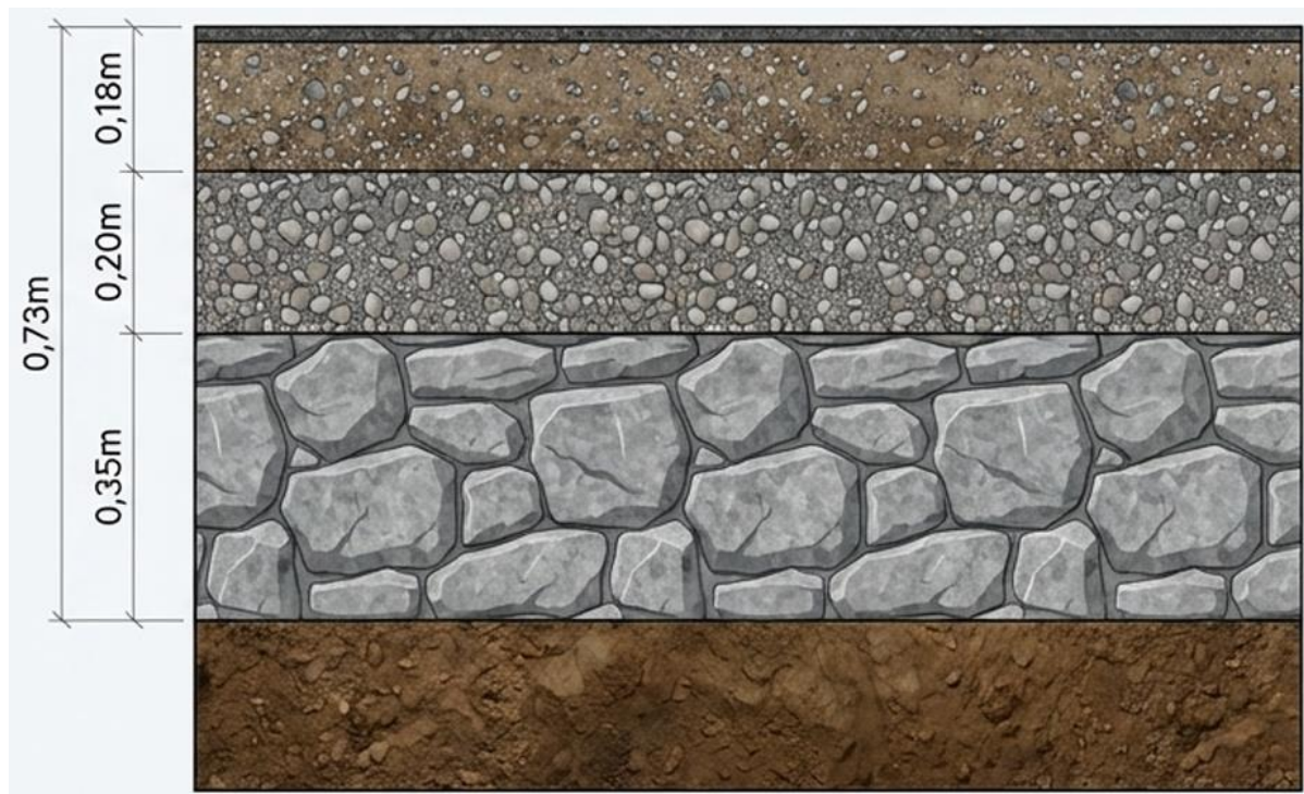
Figura 7 - Seção transversal esquemática do pavimento
