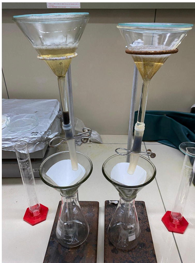
Figura 4 - Ensaio de separação em líquido denso (bromofórmio)
