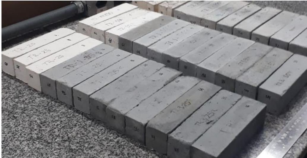
Figura 13 – Corpos de prova retirados dos moldes e identificados.
