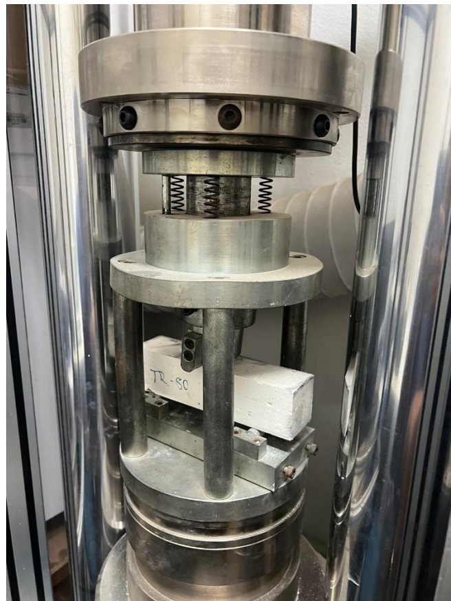
Figura 18 – Corpo de prova durante ensaio de resistência à tração.
