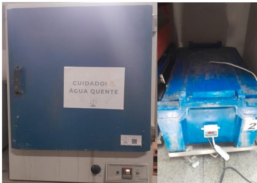
Figura 14 – a) Estufa para cura em 100°C; b) Caixa térmica para cura em 50°C e 25°C.
