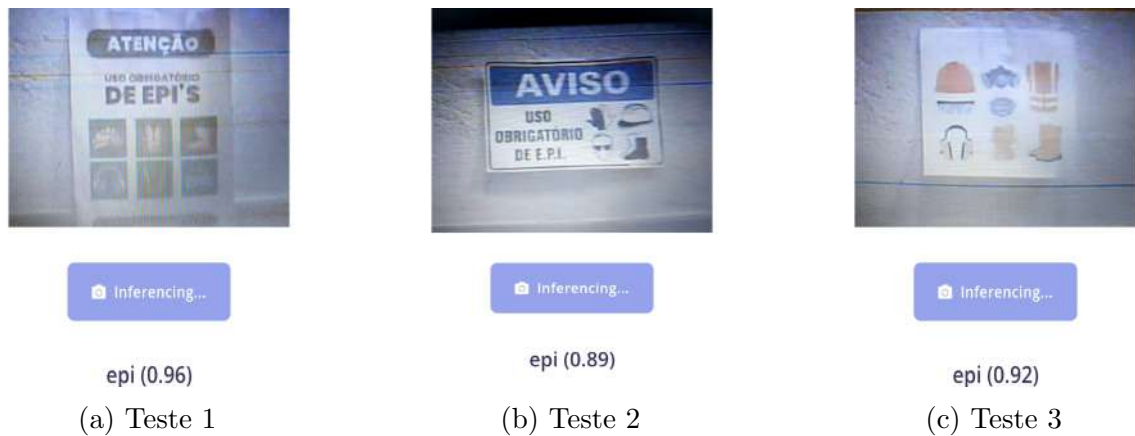
Figura 58 – Testes Dinâmicos 1 a 3: detecção da classe EPI .
