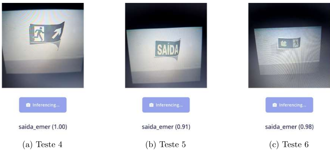
Figura 63 – Testes Dinâmicos 4 a 6: detecção da classe Saída de Emergência . Fonte: Própria autora (2026).
