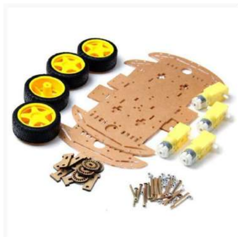
Figura 18 – Detalhe da estrutura do chassi 4WD e demais componentes Fonte: ELETROGATE (2026b)
