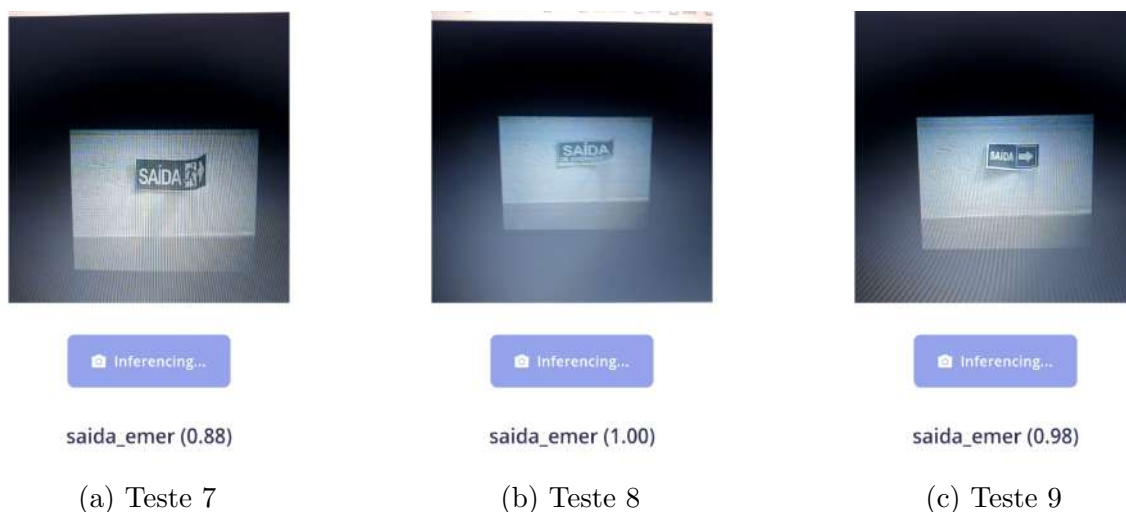
Figura 64 – Testes Dinâmicos 7 a 9: detecção da classe Saída de Emergência . Fonte: Própria autora (2026).
