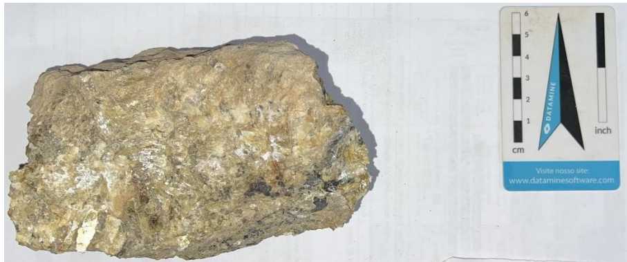
Figura 31 - Amostra utilizada para a confecção da lâmina M11MV, composta predominantemente por quartzo e mica verde.
