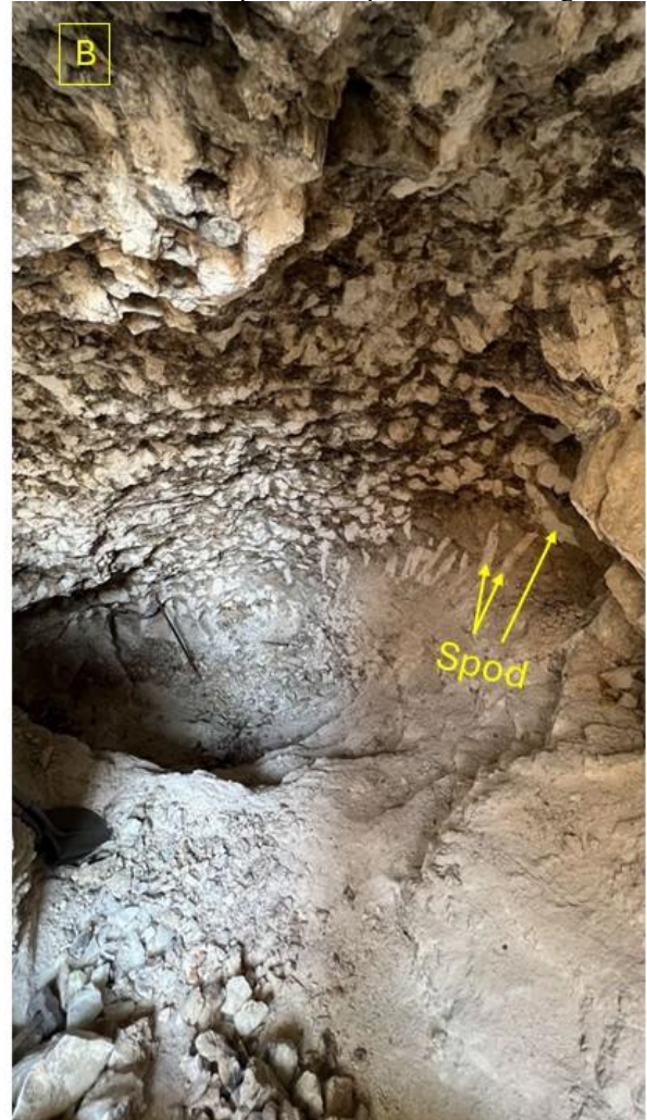
Figura 24 - A: Megacristais de espodumênio (Spod) no pegmatito Severino (TCC07). O espodumênio aparece entre cristais de feldspato (Feld) e quartzo (Qtz), crescendo perpendicularmente aos núcleos de quartzo, na parte inferior da imagem. B: Galeria no pegmatito Neves (TCC06). Pode-se observar os cristais de espodumênio (prismáticos e de cor branca) desenvolvendo-se perpendiculares ao núcleo de quartzo, na parte inferior da galeria.
