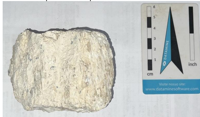
Figura 25 - Amostra de cristal de espodumênio da qual foi confeccionada a lâmina M6E.
