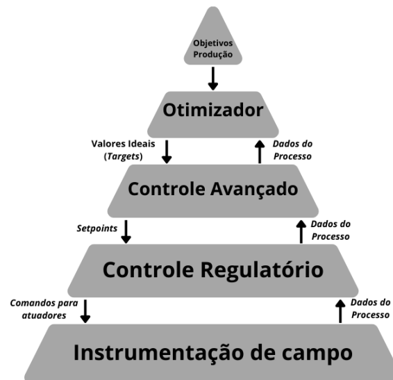
Figura 1 – Pirâmide de Controle de Processos. Fonte: Adaptada de Strutzel (2014).
