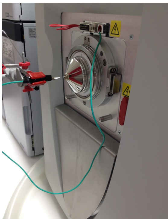
Figura 11: Montagem de uma fonte de ionização por paper spray no LaCEM.
