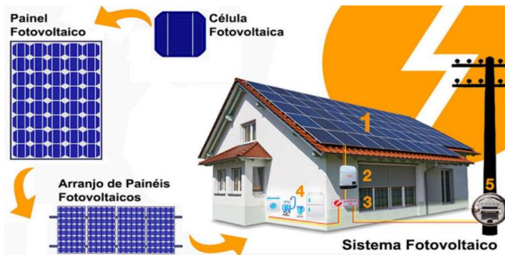
Figura 14 - Sistema Fotovoltaico on-grid .
