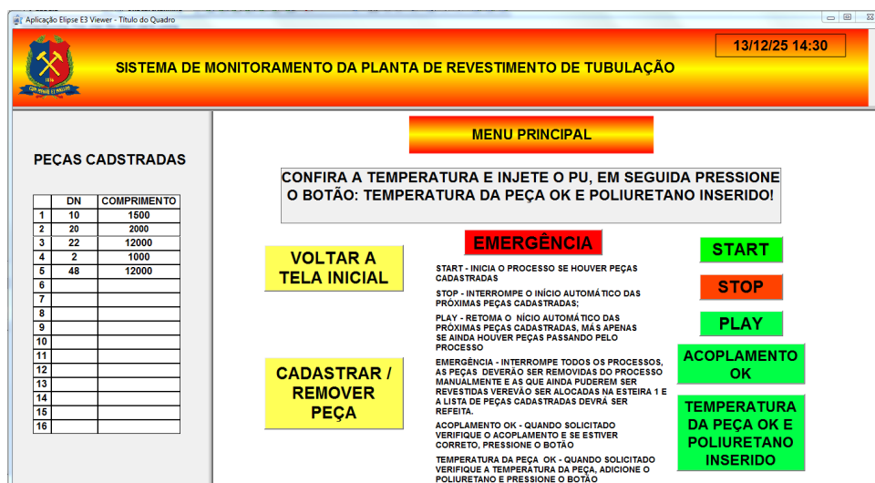
Figura 181 – Mensagem de verificação de temperatura e inserção de PU.
