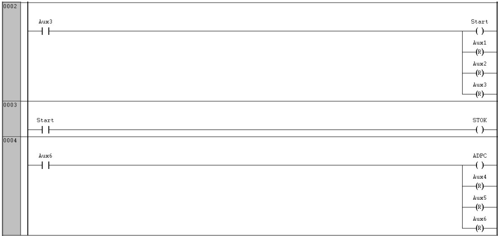
Figura 117 – Operações de Start e controle de mensagens na POU TEST_START. Fonte: Autor.
