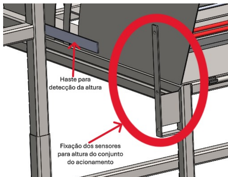
Figura 70 – Fixação dos sensores do conjunto do acionamento. Fonte: Autor.
