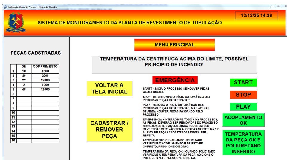
Figura 178 – Alerta de temperatura da centrífuga acima do limite.
