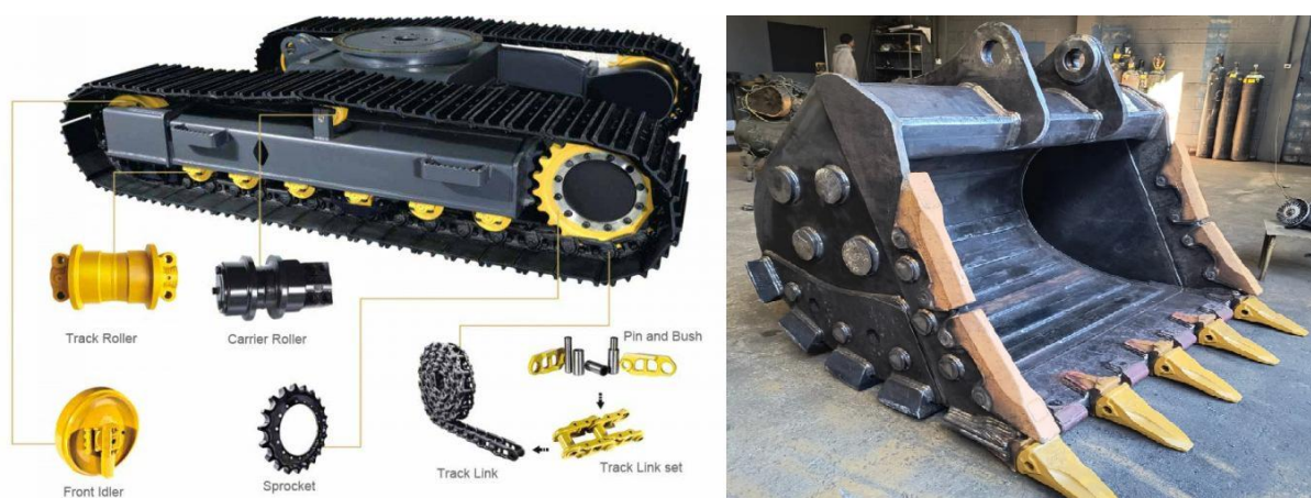
Figure 3 - Exemplos de materiais de estudo: sistema de material rodante e caçamba de escavação. Fonte: Pesquisa direta (2026).
