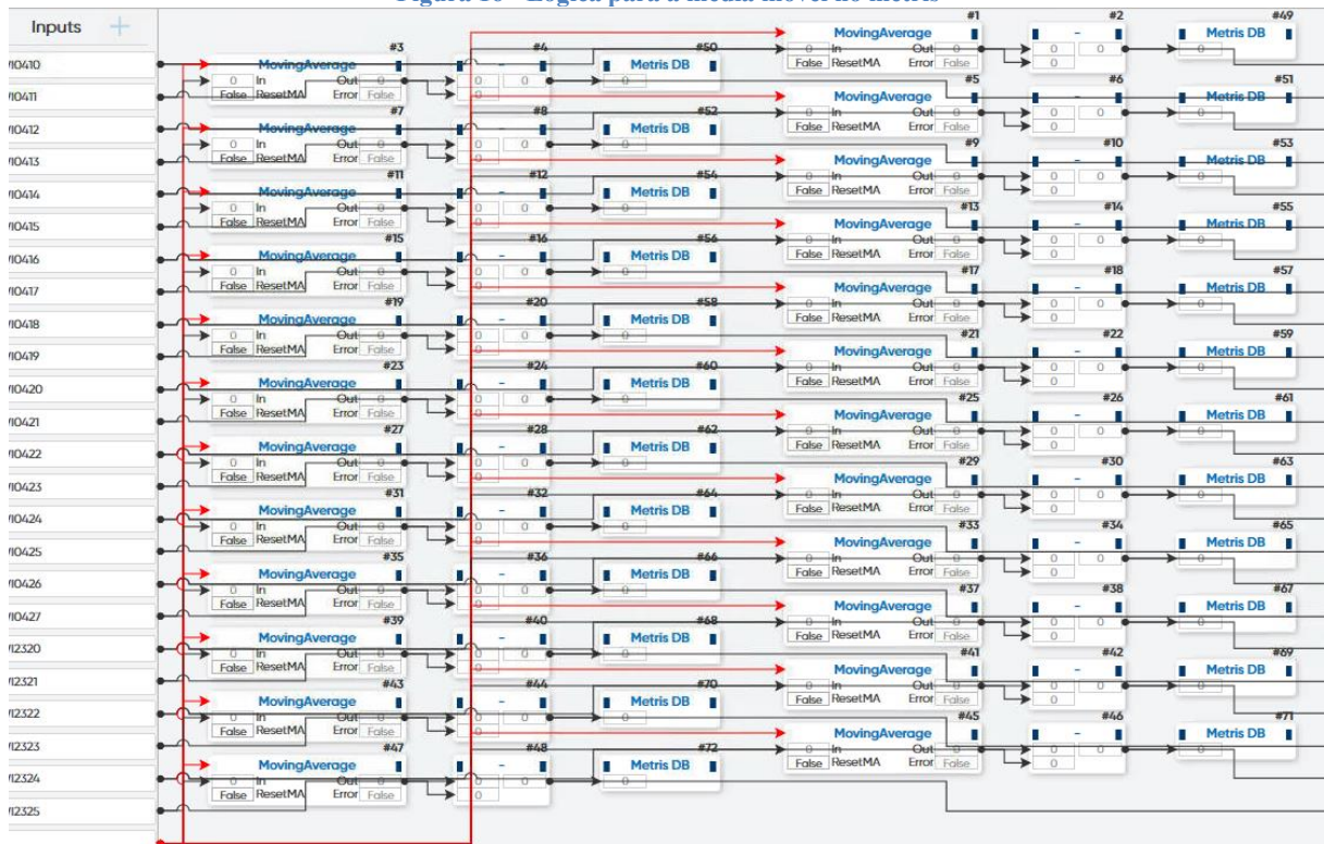
Figura 16 - Lógica para a média móvel no metris
