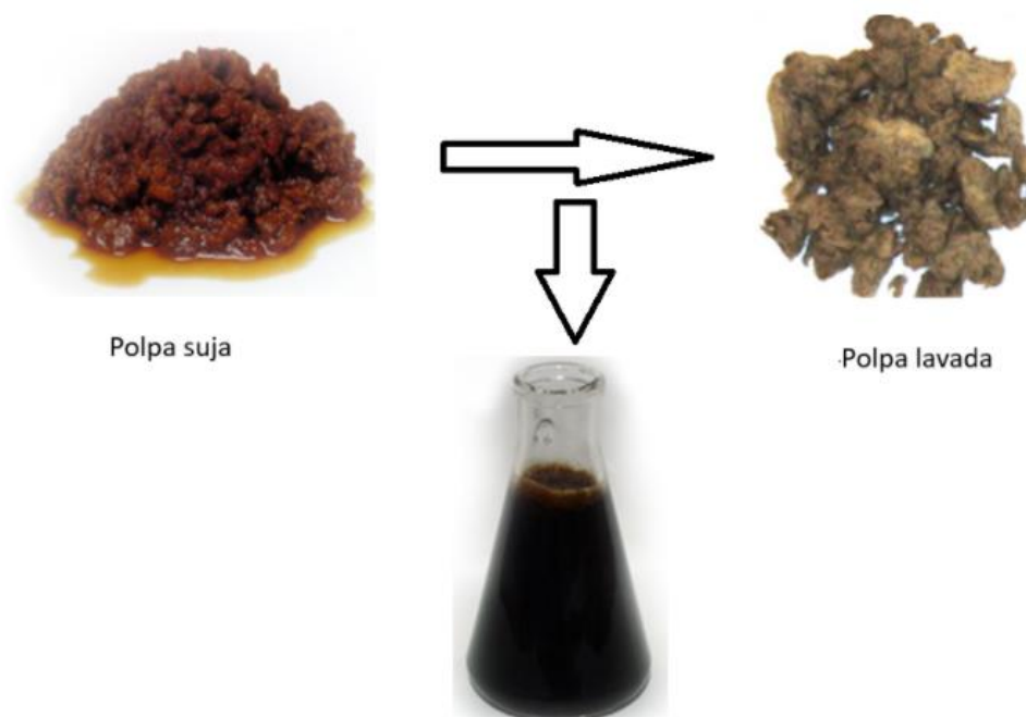
Figura 5 - Licor negro separado da polpa durante a lavagem
